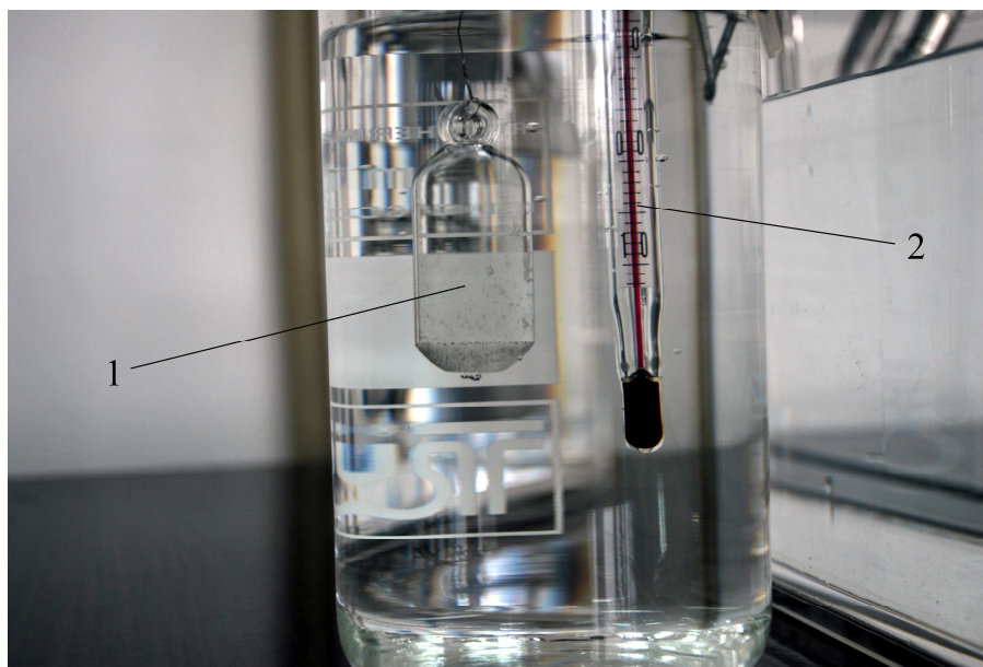
1 – погружной поплавок; 2 – термометр.
